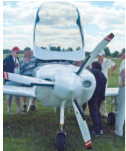
Воздушный винт MTV изменяемого шага с реверсом
