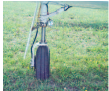
Колеса носовой и основных стоек одинаковые
